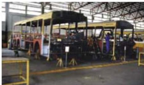
Em média, após oito anos de vida útil, os veículos são encaminhados para a nave das grandes reparações, onde são sujeitos a um programado processo de reconstrução retratado na fotografia.
