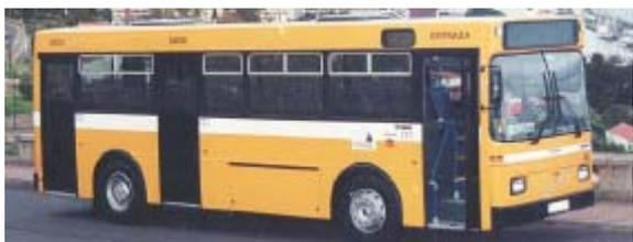
Em resultado, foram introduzidos na frota da HF os autocarros com 3 portas, sendo uma de entrada e duas de saída, com um chassis com motor central, com a traseira afunilada e com acessos com, pelo menos, três degraus (como se pode observar na imagem ao lado).
