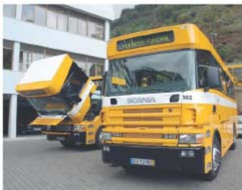
Dada a especificidade deste serviço público, no 2.º semestre de 2003, entraram em funcionamento 4 novos autocarros cujas carroçarias foram construídas nas oficinas da HF (sector das grandes reparações), em chassis 4x4 Scania.
